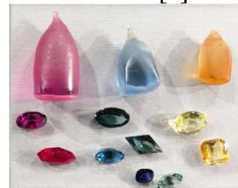
Рис. 3. Искусственно выращенный кристаллографический материал и огранённые из него ювелирные вставки
